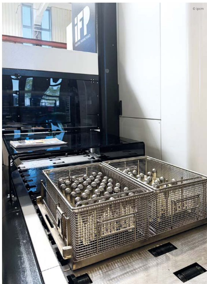
Fase di carico dell'impianto di lavaggio.
