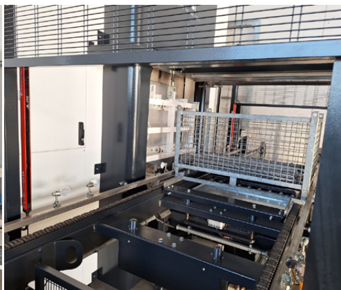
La nuova lavatrice industriale KP 600 MAX di IFP Europe installata da MOSA integra un'automazione completa, con buffer di ingresso e di uscita, capace di gestire autonomamente fino a quattro contenitori customizzati
