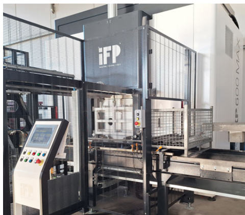
La nuova lavatrice industriale KP 600 MAX di IFP Europe installata da MOSA integra un'automazione completa, con buffer di ingresso e di uscita, capace di gestire autonomamente fino a quattro contenitori customizzati
