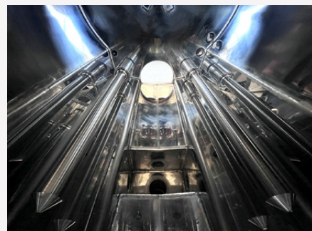
Dettaglio camera lavaggio con opzione ultrasuoni
