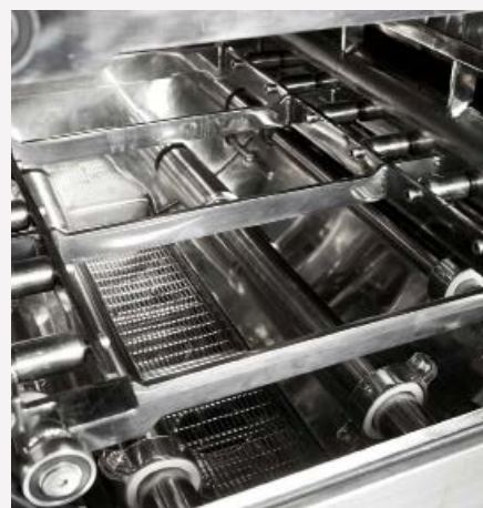
La tecnologia di lavaggio a ultrasuoni degli impianti lfp Europe risulta molto efficace su componenti particolarmente complessi come quelli processati da Rep Trattamenti
