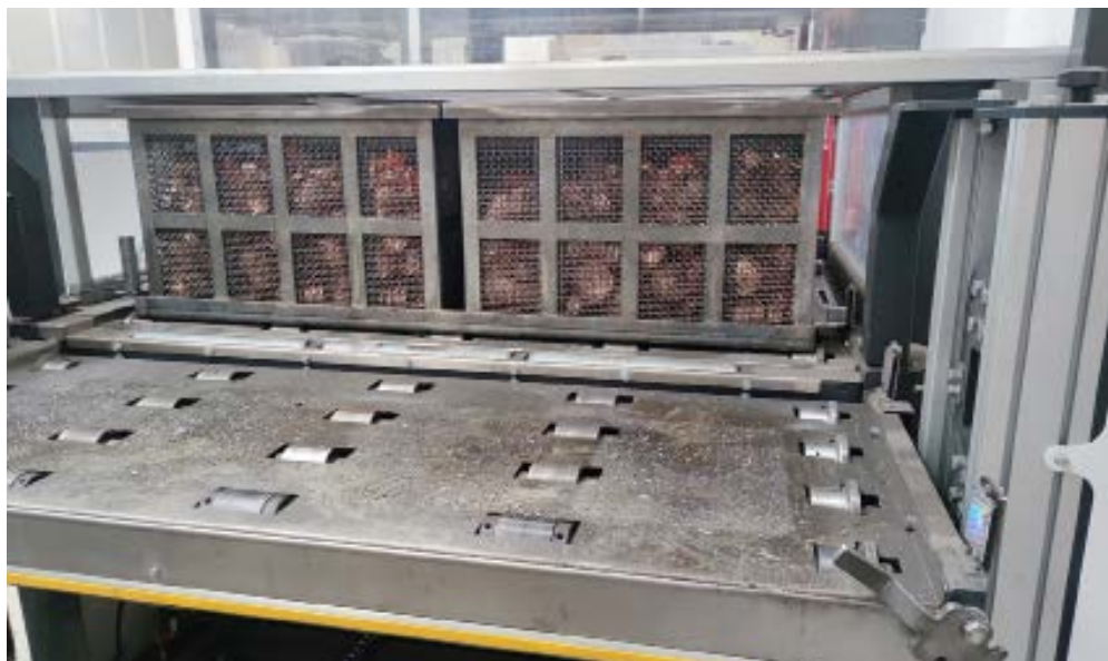
L'installazione in Rep Trattamenti del nuovo impianto di lavaggio KP400 HMA di Ipf Europe ha previsto anche la contemporanea integrazione di una camera bianca, che consente il confezionamento post-lavaggio in ambiente controllato per evitare contaminazioni
