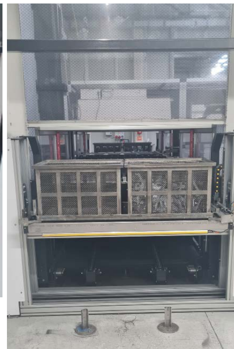
L'installazione in Rep Trattamenti del nuovo impianto di lavaggio KP400 HMA di Ipf Europe ha previsto anche la contemporanea integrazione di una camera bianca, che consente il confezionamento post-lavaggio in ambiente controllato per evitare contaminazioni
