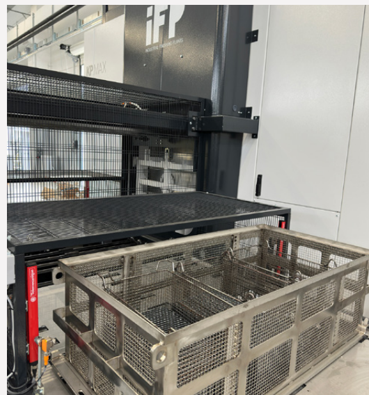
L'impianto fornito da IFP Europe è stato configurato con dotazioni mirate a ottimizzare i flussi produttivi, tra cui una rulliera automatica per l'introduzione delle ceste
