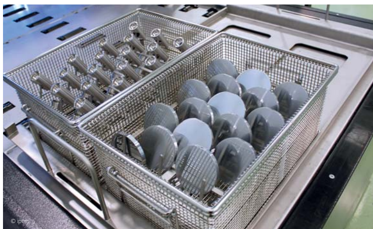
Parts with different shapes arranged in the standard baskets. Alcuni dei manufatti di diversa conformazione nei cestelli standard.
