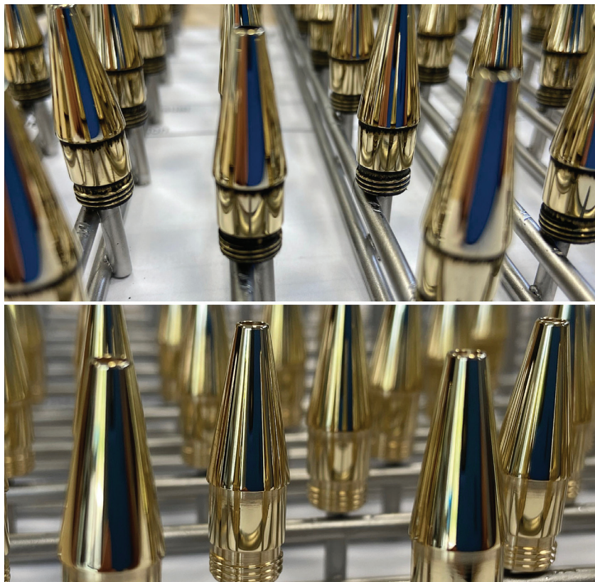
Pointes de stylo en laiton après polissage (en haut) et après lavage sur une machine IFP.
