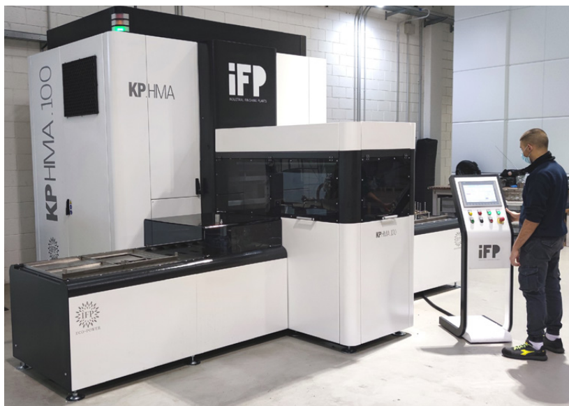
Vista del nuovo impianto di lavaggio IFP Europe KP.HMA 100 Glass acquisito da MICROingranaggi nella versione completa di lavaggio a ultrasuoni e di automazione di carico e scarico
