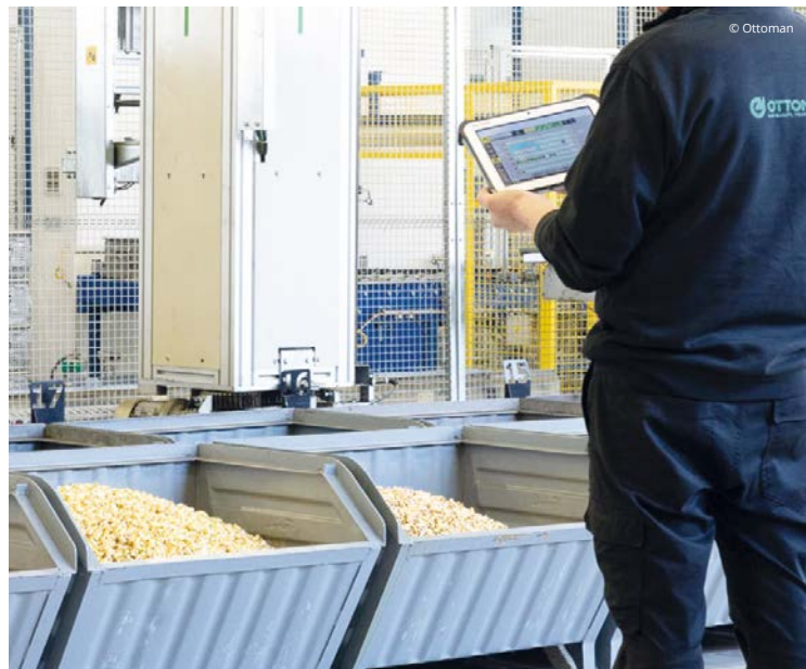
The baskets are fitted with microchips to ensure complete traceability of each component. La raccolta dei pezzi lavati nei cesti dotati di microchip per la tracciabilità di ciascun componente.
