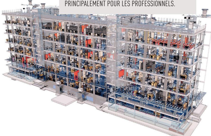
La société S3D Engineering se rend sur place afin de scanner le bâtiment avec un scanner laser 3D de chez Leica. Elle crée le jumeau numérique du bâtiment, avec des plans côtés (intérieur et extérieur). Elle fournit alors au client les fichiers à intégrer dans les logiciels métier. Le client dispose de plans 2D et modélisation 3D. Ces fichiers sont utiles pour l'aménagement d'un bâtiment lors de sa rénovation. Il peut ainsi modéliser les passages de conduite d'air, d'eau...
