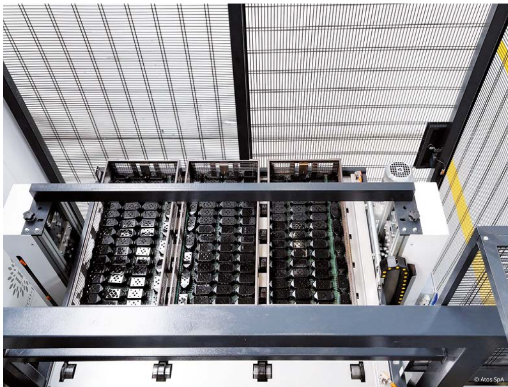
Frame del passaggio dei cesti dal piano inferiore a quello superiore della rulliera.
