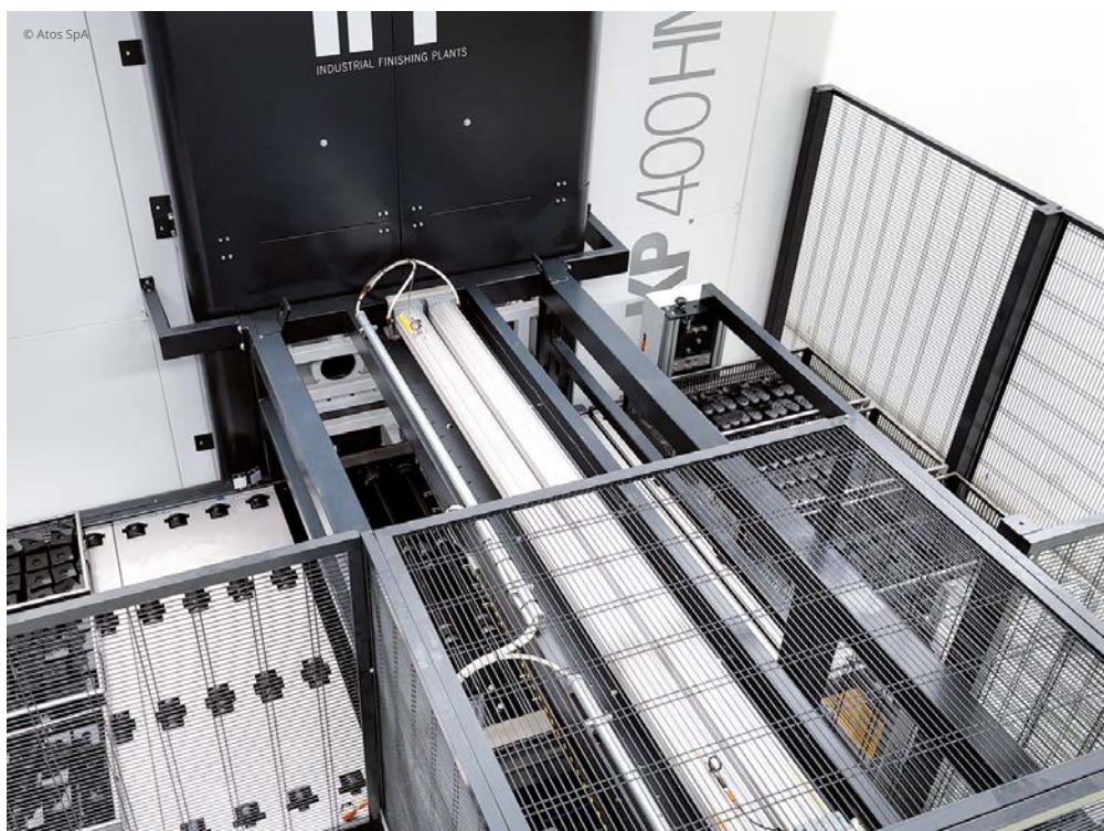
Dettaglio del dispositivo di trasporto dei cesti nella camera di lavaggio.
