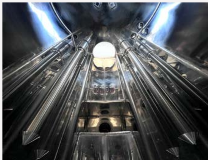
Il nuovo impianto di lavaggio KP 100.HMA installato da Nuova Saimpa è dotato di un generatore con trasduttori a ultrasuoni, che garantisce un'azione pulente profonda
