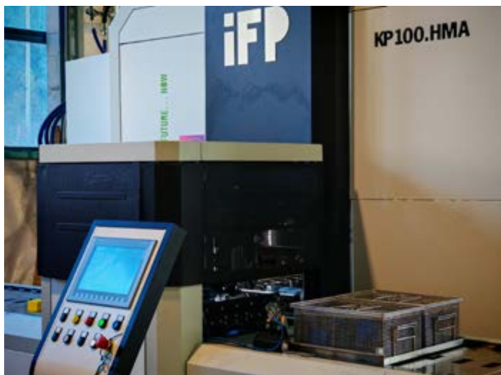
La nuova KP 100.HMA di IFP Europe installata da Nuova Saimpa gestisce in autonomia fino a 8 cesti
